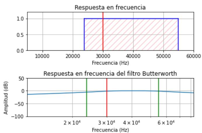
*Figura 46 Prueba respuesta en frecuencia AM VSB*
