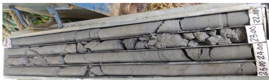
ILUSTRACIÓN 45 - MUESTRA #6 RECUPERADA, SONDEO P4 – 21,00 M – 25,00 M (FUENTE: PROPIA)
