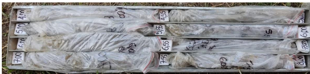
ILUSTRACIÓN 25 - MUESTRA #2 RECUPERADA, SONDEO P2 – 4,00 M – 8,00 M (FUENTE: PROPIA)
