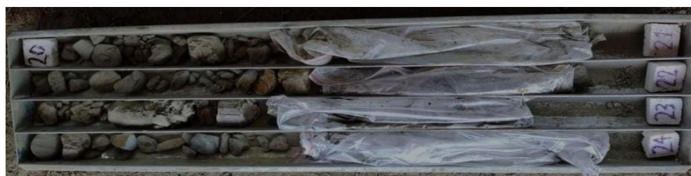
ILUSTRACIÓN 37 - MUESTRA #6 RECUPERADA, SONDEO P3 – 20,00 M – 24,00 M (FUENTE: PROPIA)
