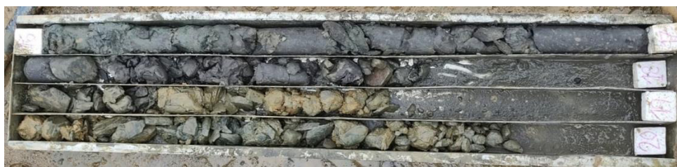
ILUSTRACIÓN 36 - MUESTRA #5 RECUPERADA, SONDEO P3 – 16,00 M – 20,00 M (FUENTE: PROPIA)
