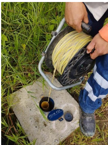
ILUSTRACIÓN 53 – PUNTO DE CONTROL P2 – PIEZÓMETRO 02 (FUENTE: PROPIA)
