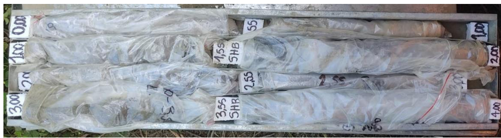
ILUSTRACIÓN 24 - MUESTRA #1 RECUPERADA, SONDEO P2 – 0,00 M – 4,00 M (FUENTE: PROPIA)
