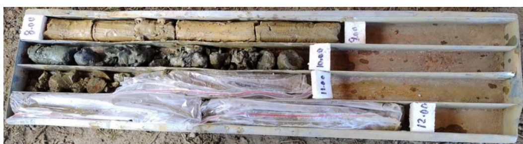
ILUSTRACIÓN 34 - MUESTRA #3 RECUPERADA, SONDEO P3 – 8,00 M – 12,00 M (FUENTE: PROPIA)
