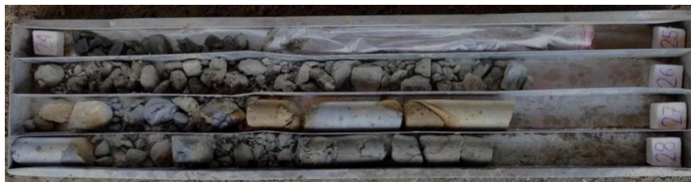
ILUSTRACIÓN 38 - MUESTRA #7 RECUPERADA, SONDEO P3 – 24,00 M – 28,00 M (FUENTE: PROPIA)
