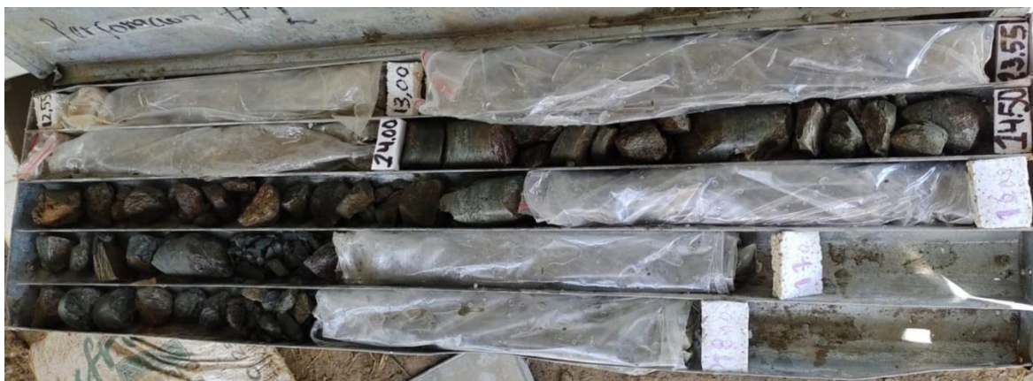
ILUSTRACIÓN 20 - MUESTRA #4 RECUPERADA, SONDEO P1 – 12,55 M – 18,00 M (FUENTE: PROPIA)
