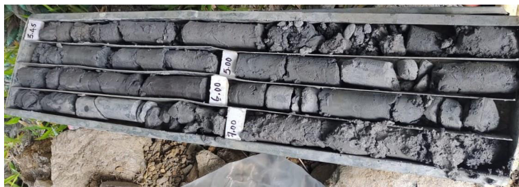
ILUSTRACIÓN 41 - MUESTRA #2 RECUPERADA, SONDEO P4 – 3,45 M – 8,00 M (FUENTE: PROPIA)
