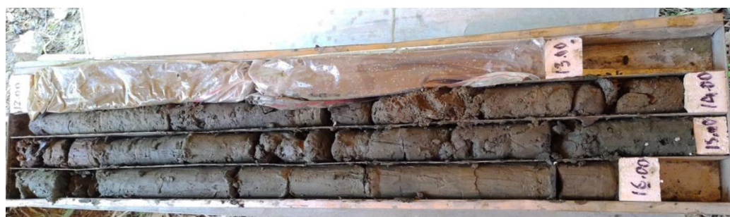
ILUSTRACIÓN 35 - MUESTRA #4 RECUPERADA, SONDEO P3 – 12,00 M – 16,00 M (FUENTE: PROPIA)
