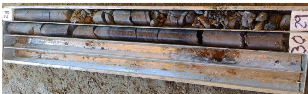
ILUSTRACIÓN 39 - MUESTRA #8 RECUPERADA, SONDEO P3 – 28,00 M – 30,00 M (FUENTE: PROPIA)
