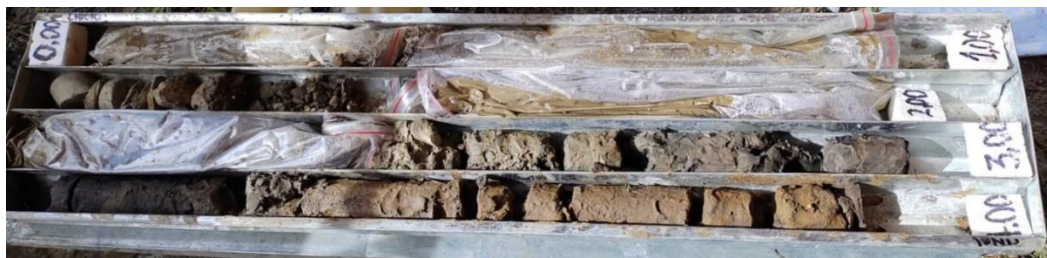
ILUSTRACIÓN 32 - MUESTRA #1 RECUPERADA, SONDEO P3 – 00,00 M – 4,00 M (FUENTE: PROPIA)
