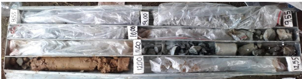
ILUSTRACIÓN 19 - MUESTRA #3 RECUPERADA, SONDEO P1 – 8,55 M – 12,55 M (FUENTE: PROPIA)
