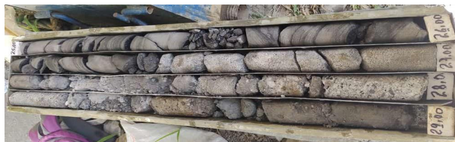
ILUSTRACIÓN 46 - MUESTRA #7 RECUPERADA, SONDEO P4 – 25,00 M – 29,00 M (FUENTE: PROPIA)
