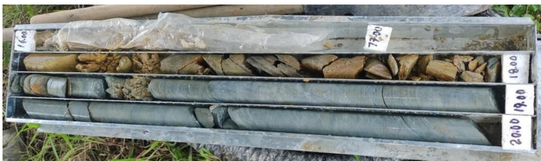
ILUSTRACIÓN 28 - MUESTRA #5 RECUPERADA, SONDEO P2 – 16,00 M – 20,00 M (FUENTE: PROPIA)
