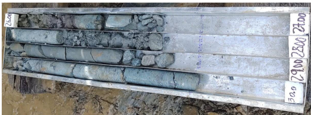
ILUSTRACIÓN 23 - MUESTRA #7 RECUPERADA, SONDEO P1 – 26,00 M – 30,00 M (FUENTE: PROPIA)
