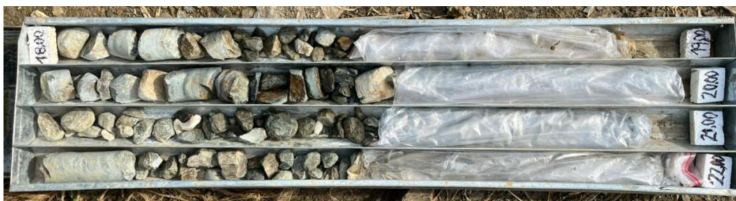
ILUSTRACIÓN 21 - MUESTRA #5 RECUPERADA, SONDEO P1 – 18,00 M – 22,00 M (FUENTE: PROPIA)
