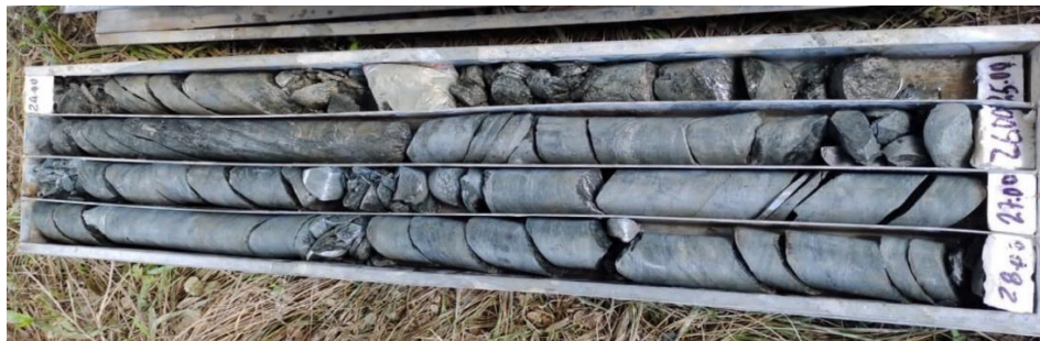
ILUSTRACIÓN 30 - MUESTRA #6 RECUPERADA, SONDEO P2 – 24,00 M – 28,00 M (FUENTE: PROPIA)
