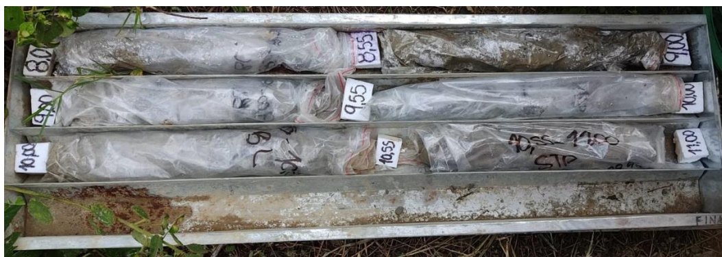
ILUSTRACIÓN 26 - MUESTRA #3 RECUPERADA, SONDEO P2 – 8,00 M – 11,00 M (FUENTE: PROPIA)
