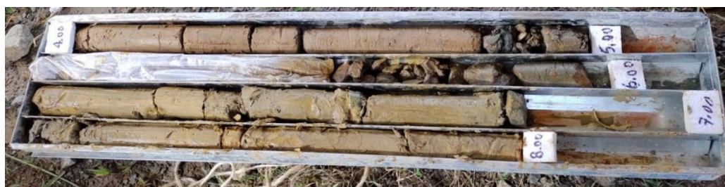
ILUSTRACIÓN 33 - MUESTRA #2 RECUPERADA, SONDEO P3 – 4,00 M – 8,00 M (FUENTE: PROPIA)
