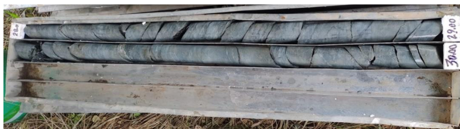
ILUSTRACIÓN 31 - MUESTRA #7 RECUPERADA, SONDEO P2 – 28,00 M – 30,00 M (FUENTE: PROPIA)
