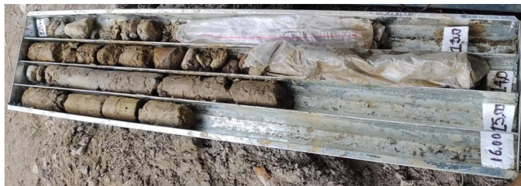
ILUSTRACIÓN 27 - MUESTRA #4 RECUPERADA, SONDEO P2 – 11,00 M – 16,00 M (FUENTE: PROPIA)
