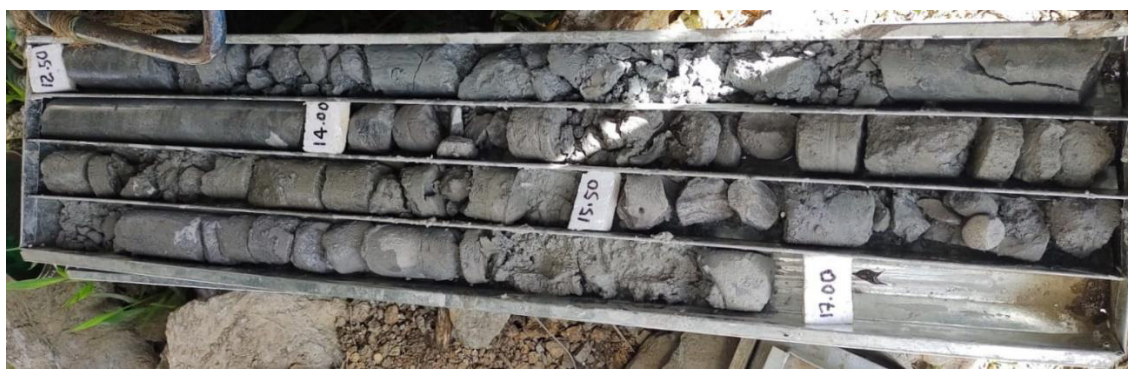
ILUSTRACIÓN 43 - MUESTRA #4 RECUPERADA, SONDEO P4 – 12,50 M – 17,00 M (FUENTE: PROPIA)
