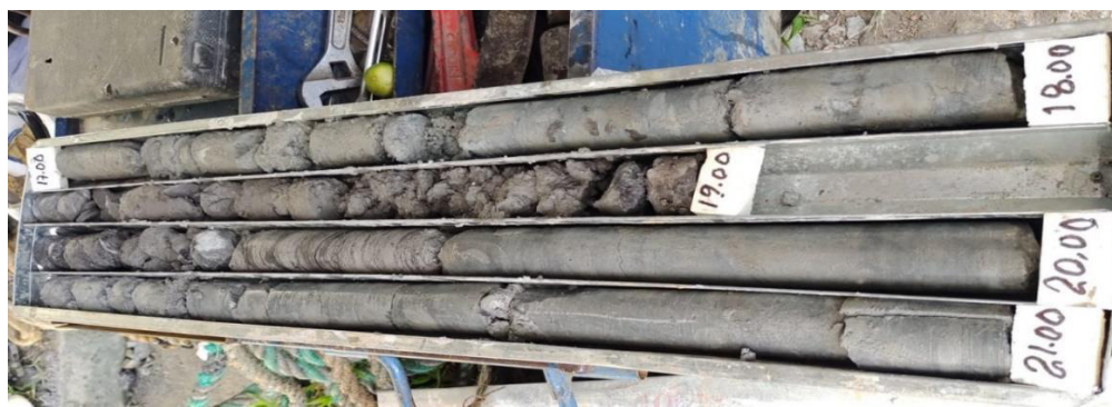
ILUSTRACIÓN 44 - MUESTRA #5 RECUPERADA, SONDEO P4 – 17,00 M – 21,00 M (FUENTE: PROPIA)
