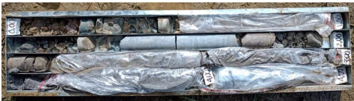
ILUSTRACIÓN 17 – MUESTRA #1 RECUPERADA, SONDEO P1 – 0,00 M - 4.55 M (FUENTE: PROPIA)
