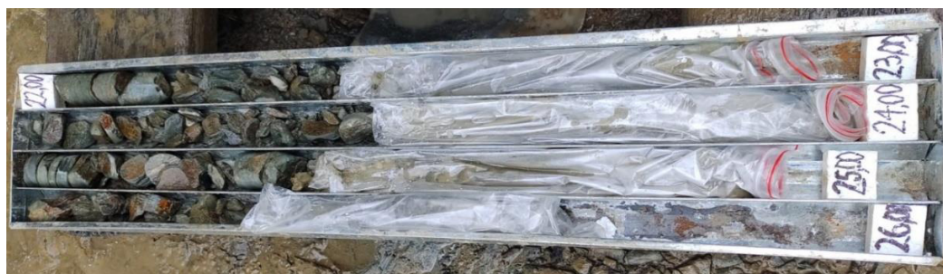
ILUSTRACIÓN 22 - MUESTRA #6 RECUPERADA, SONDEO P1 – 22,00 M – 26,00 M (FUENTE: PROPIA)
