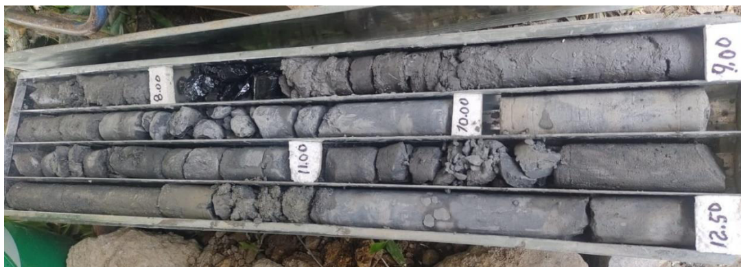
ILUSTRACIÓN 42 - MUESTRA #3 RECUPERADA, SONDEO P4 – 8,00 M – 12,50 M (FUENTE: PROPIA)
