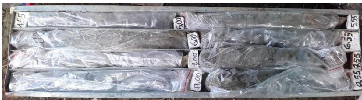
ILUSTRACIÓN 18- MUESTRA #2 RECUPERADA, SONDEO P1 – 4,55 M – 8,55 M (FUENTE: PROPIA)
