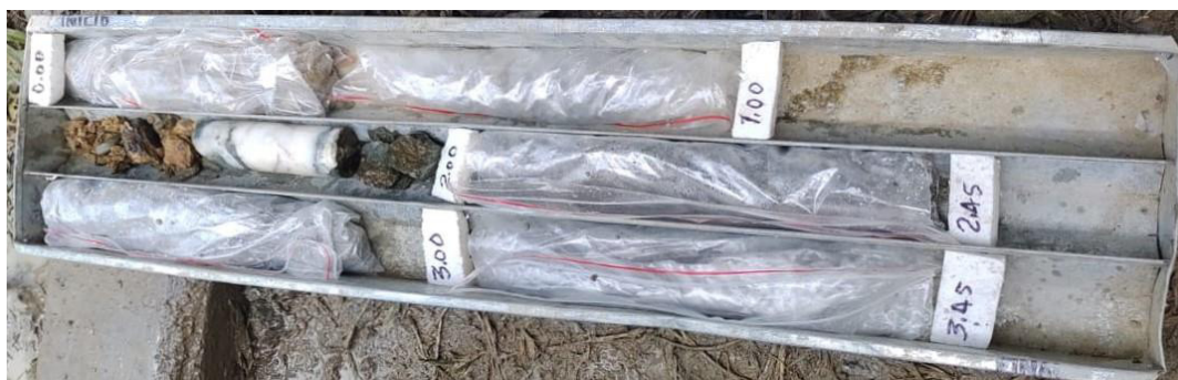
ILUSTRACIÓN 40 - MUESTRA #1 RECUPERADA, SONDEO P4 – 0,00 M – 3,45 M (FUENTE: PROPIA)
