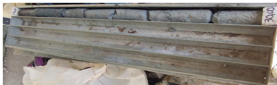
ILUSTRACIÓN 47 - MUESTRA #8 RECUPERADA, SONDEO P4 – 29,00 M – 30,00 M (FUENTE: PROPIA)
