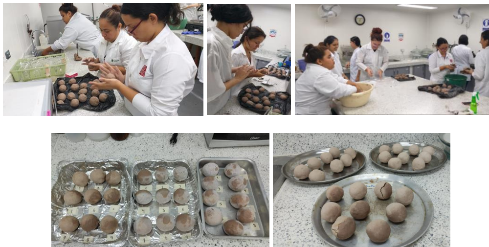
Figura 7 Elaboración de las bombas de arcilla para el experimento definitivo
