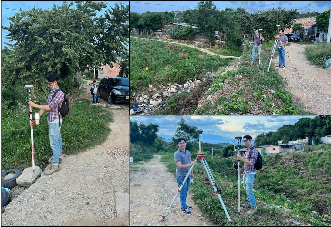
*Figura 11.* Levantamiento topográfico en RTK
