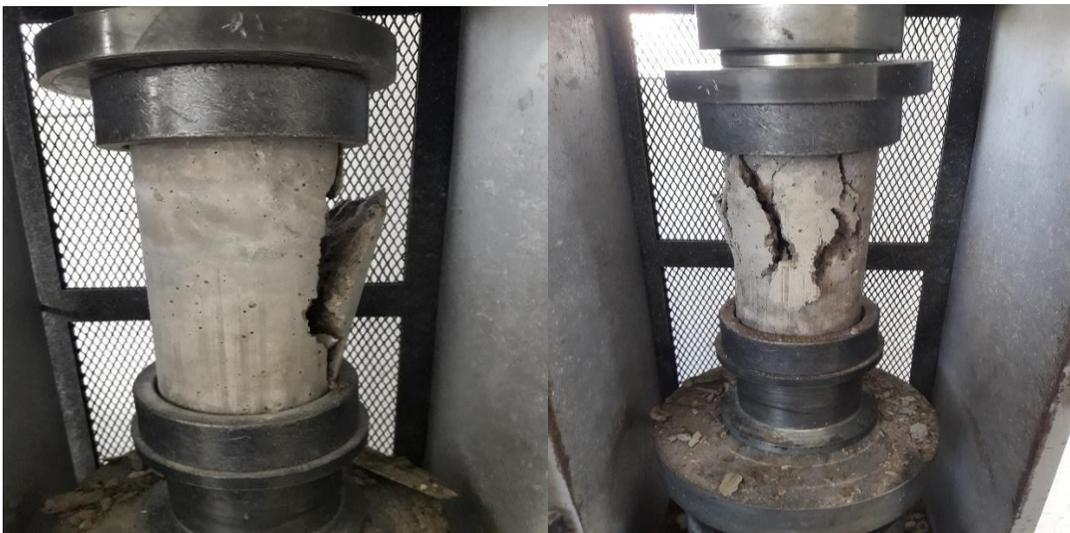
**Figura 7. Ensayo resistencia a la compresión**
