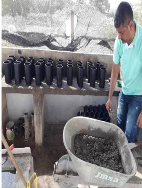
**Figura 4. Elaboración de especímenes de concreto**
