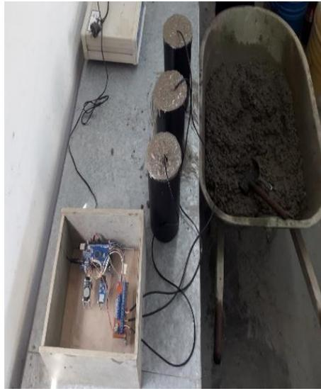
**Figura 12. Los especímenes con sus sensores conectados al circuito medidor.**
