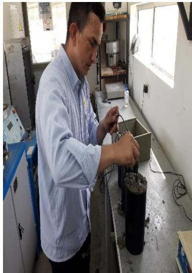
**Figura 11. Introducción del sensor a los especímenes de concreto**
