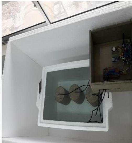
**Figura 13. Especímenes de concreto en la cámara adiabática – Método de Calorimetría**
