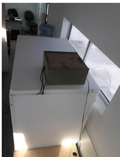
**Figura.9. Cámara adiabática sellada con su respectiva salida para los sensores**
