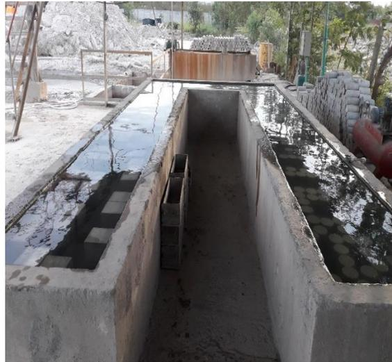
**Figura 6. Curado de cilindros en tanque de agua**
