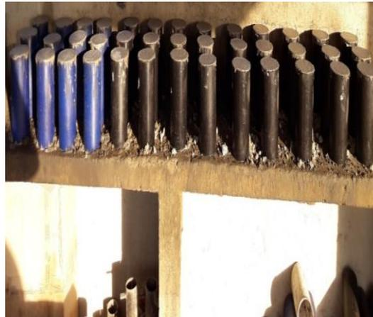
**Figura 5. Especímenes de concreto terminados**
