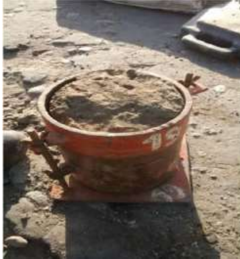
Figura 22 Molde para la toma de CBR inalterado
