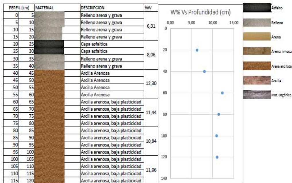
Figura 25 Perfil estratigráfico apique 2 K44+760
