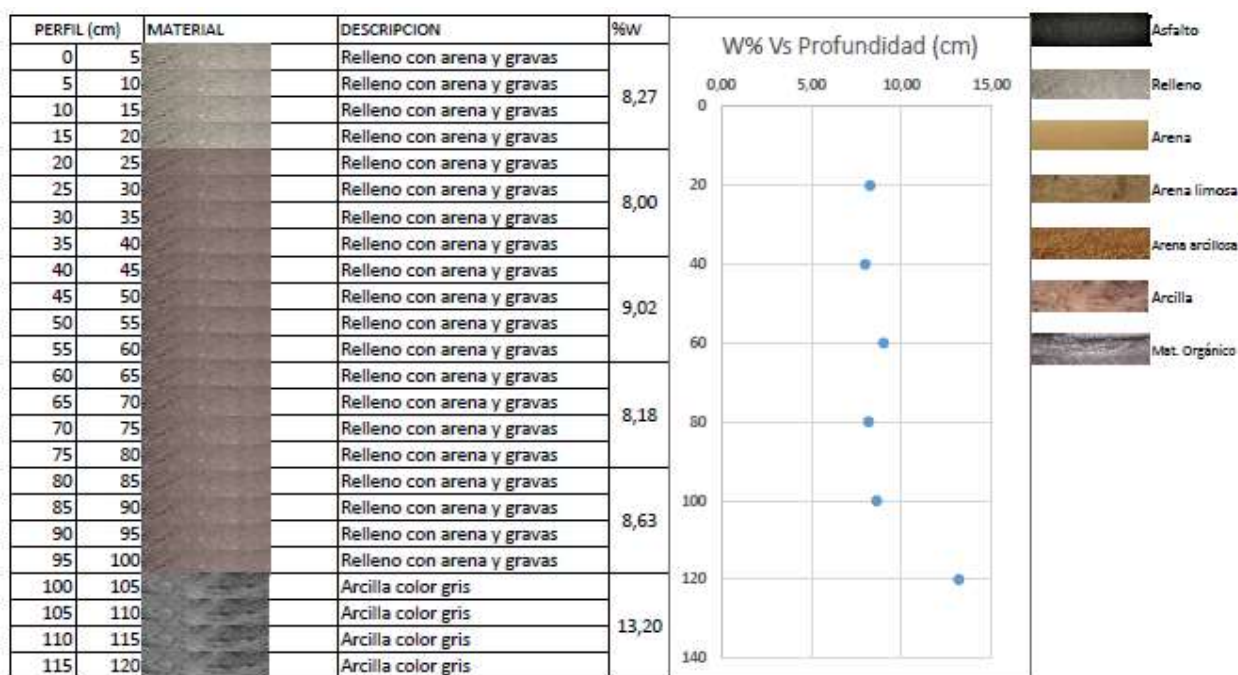
Figura 24 Perfil estratigráfico apique 1 K44+460
