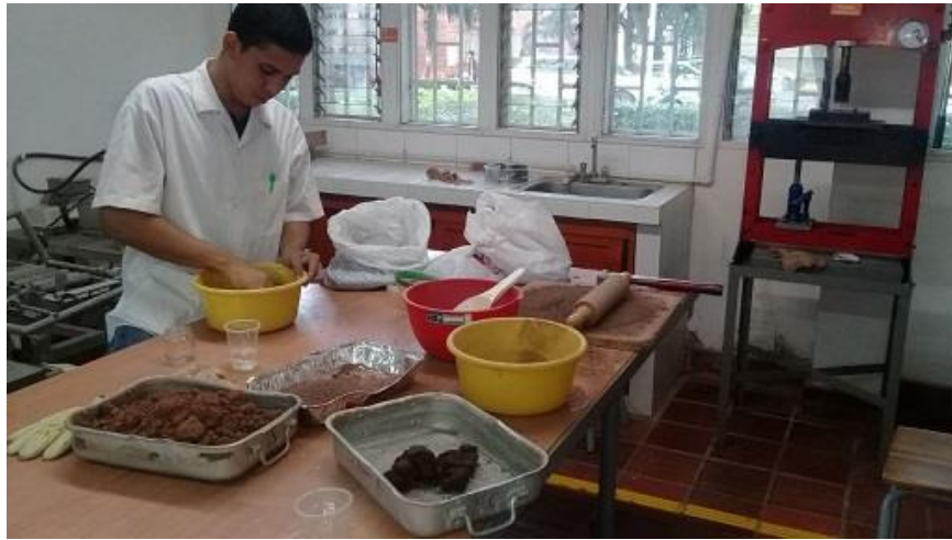
Figura 16. Humectación y amasado del material
