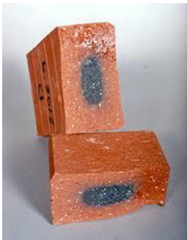
Figura 26. Pieza que presenta núcleo de reducción (corazón negro)
