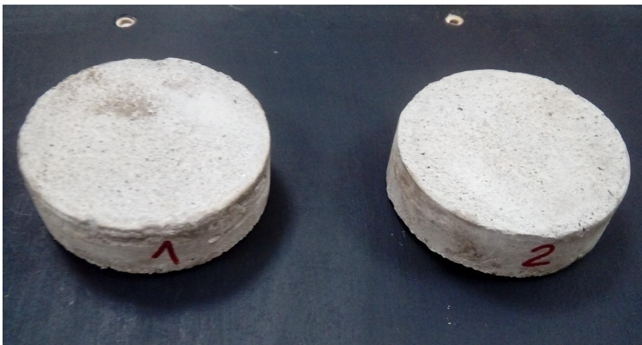
Figura 26. Probetas de cemento Portland, utilizadas para medir la densidad aparente.
