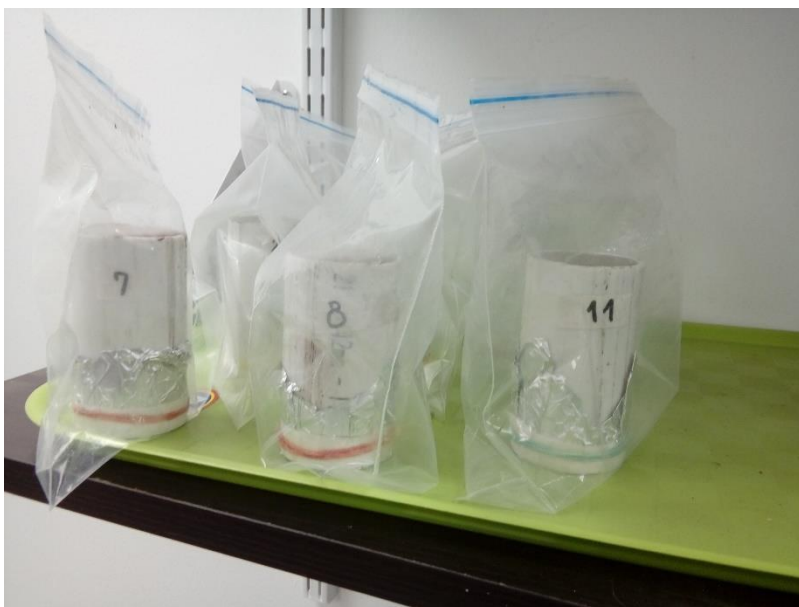
Figura 21. Muestras que se iban a usar para el ensayo de compresión en curado CCM.
