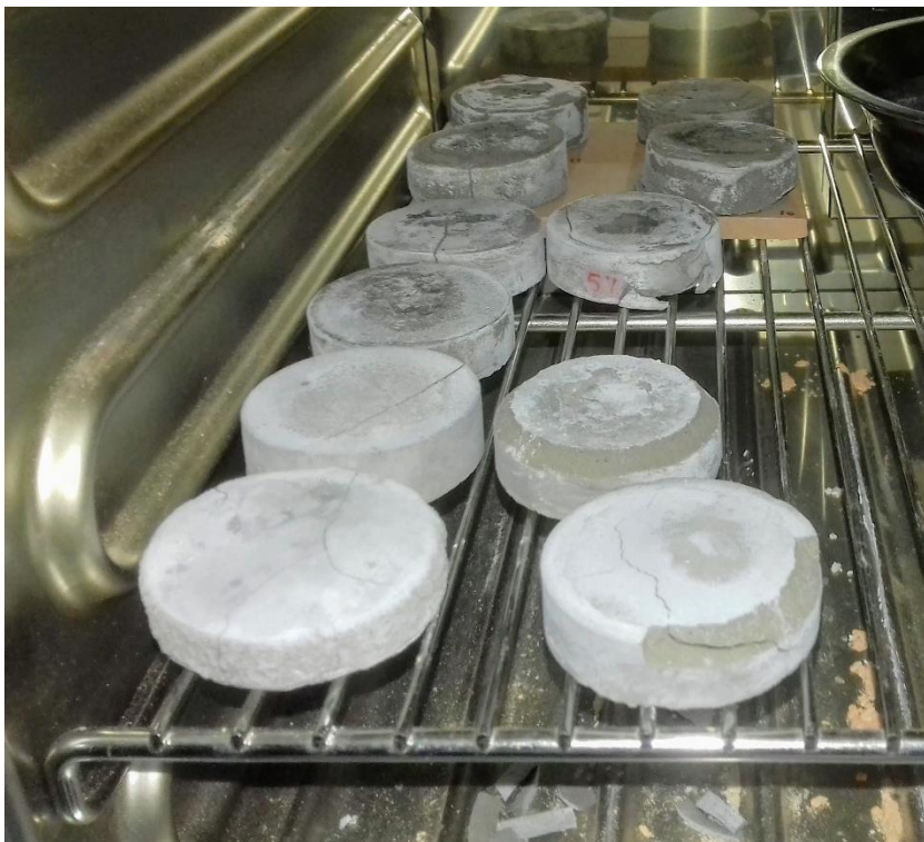
Figura 14. Muestras sin contenido de \text{SiO}_2 y sin tratamiento térmico de las cenizas 2 . Se puede observar las grietas en las probetas y la presencia de carbón.
