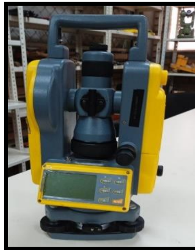
Ilustración 2. Teodolito electrónico el Spectra Precisión DET-2. Fuente: Laboratorio de Topografía UFPS
