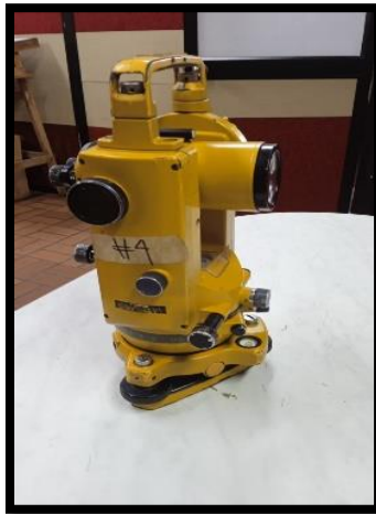
Ilustración 1. Teodolito Mecánico (Topcon TL- 6). Fuente: Laboratorio de Topografía UFPS
