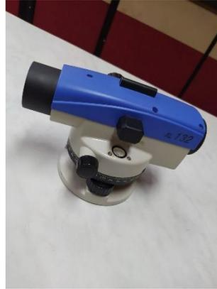
*Ilustración 3. Nivel de Precisión*
