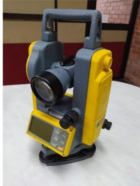
**Ilustración 2. Teodolito Electrónico (Spectra Precisión DET-2)**
