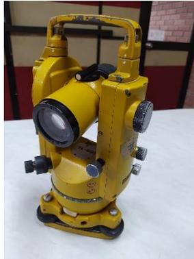
*Ilustración 1. Teodolito Mecánico (Topcon TL-6)*
