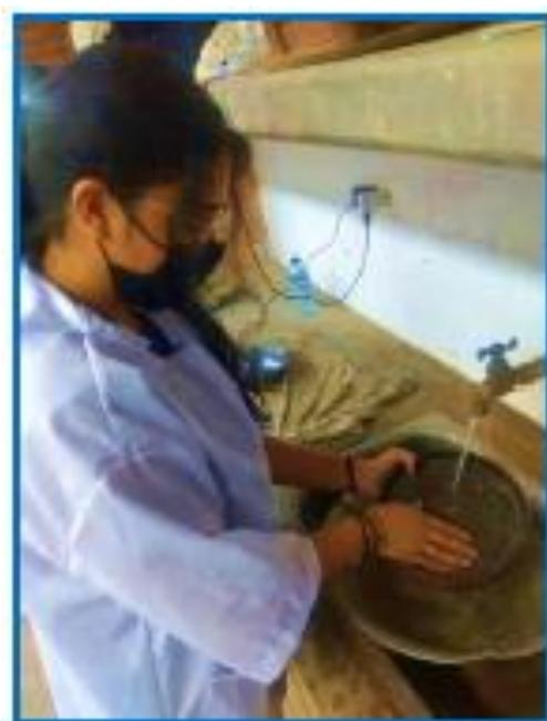
**Figura 22. Ensayo tamiz No 200**
