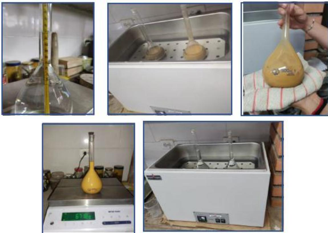
**Figura 28. Ensayo de gravedad específica y baño maría**
