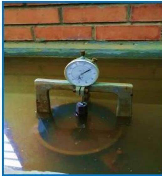
**Figura 11. Medida de expansión axial**
