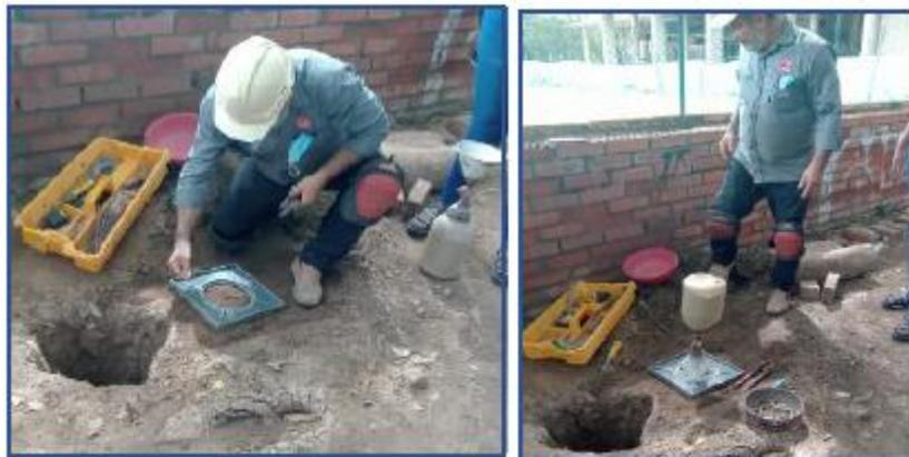
**Figura 29. Ensayo de cono y arena**
