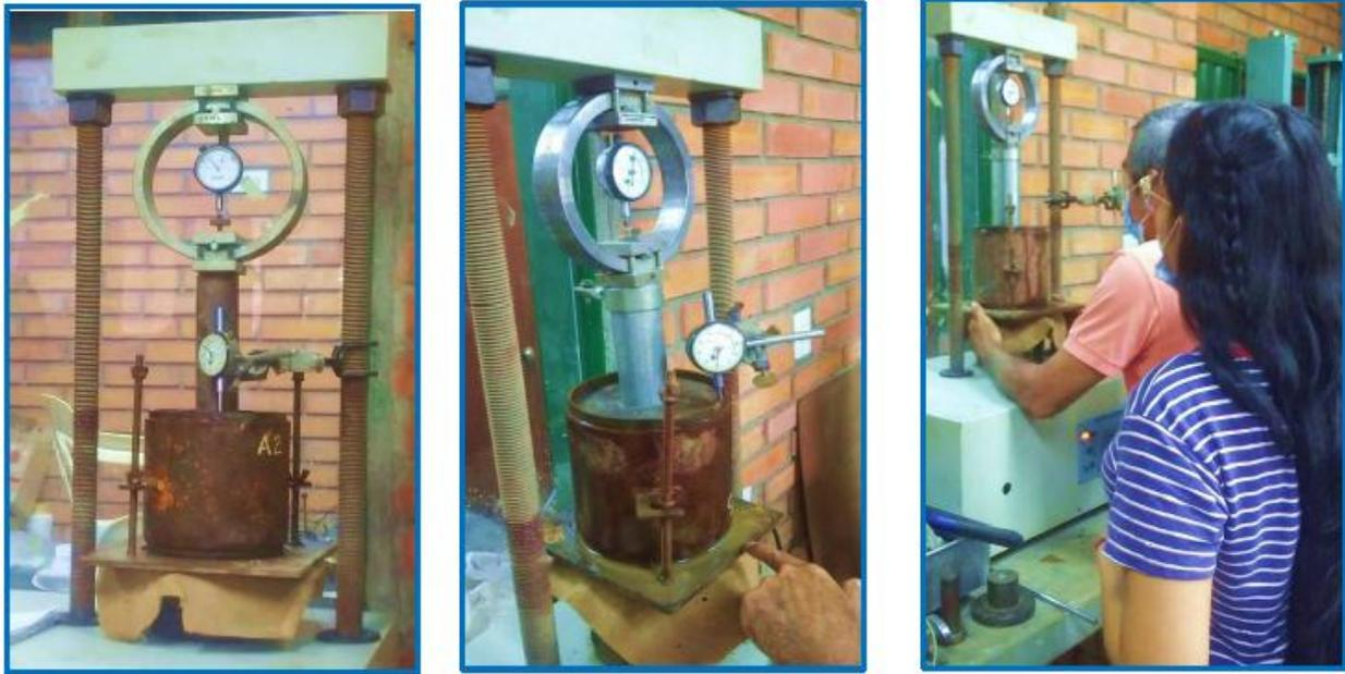
**Figura 10. Ensayo de penetración**
