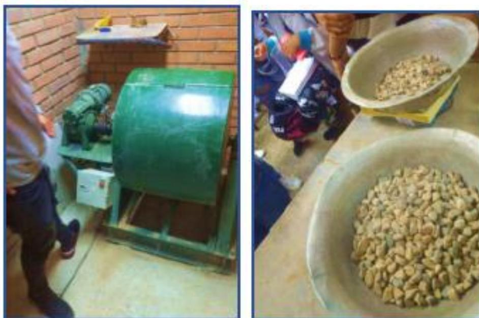
**Figura 27. Ensayo maquina de los ángeles**
