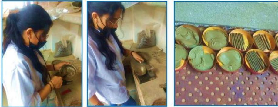
**Figura 20. Ensayo de limites**
