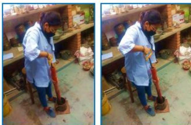
**Figura 26. Ensayo modificado de compactación**
