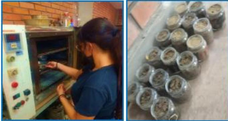
**Figura 24. Ensayo de humedad**
