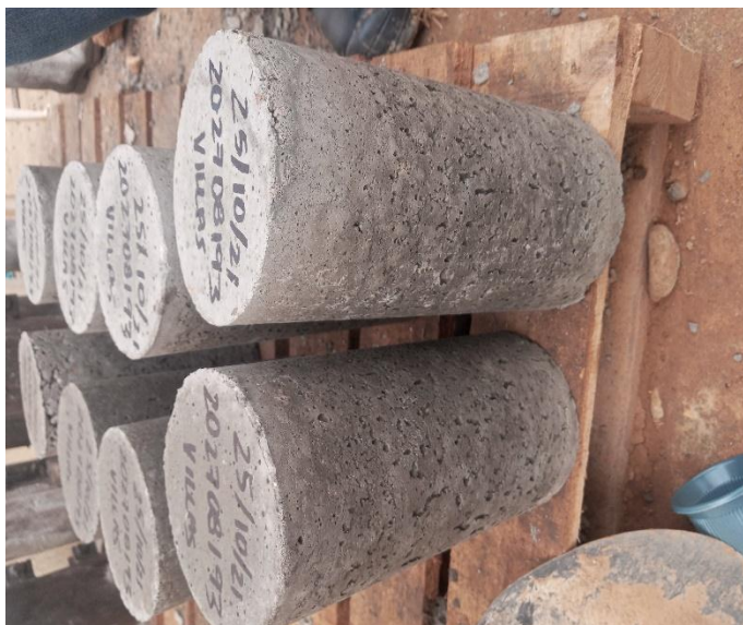
Figura 29. Evidencia en la toma de muestras del concreto con su fecha
