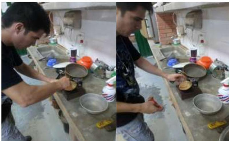
**Fotografía 4: Ensayo de límite Plástico**
