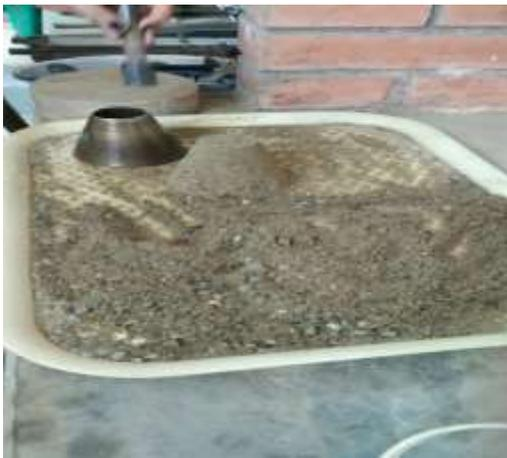
**Fotografía 16: Ensayo absorción del agregado grueso**
