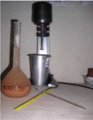
**Fotografía 6: Ensayo Equivalente de Arena**
