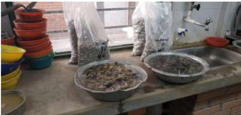
**Fotografía 17: Ensayo de caras fracturadas al agregado grueso**
