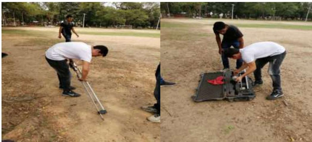
**Fotografía 21: Ensayo de cbr inalterado**
