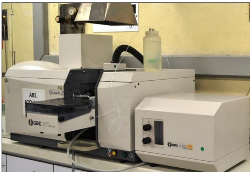
Figura 12. Espectrómetro de absorción atómica GBC modelo AVANTA Σ. Fuente: laboratorios de análisis instrumental de la Universidad Nacional de Colombia sede Medellín.
