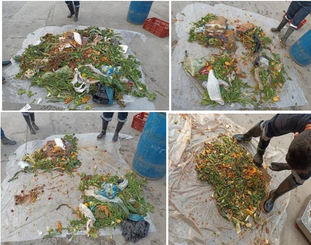
Figura 14. Caracterización de residuos sólidos por el método de cuarteo
