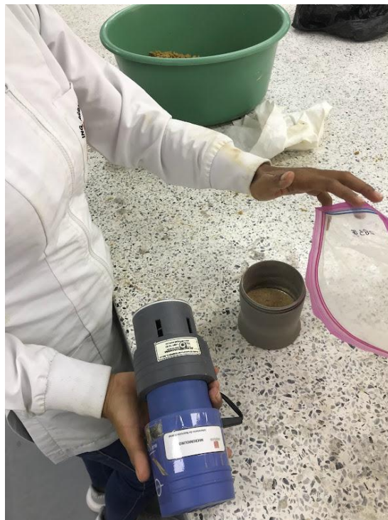
Figura 13. Molido del bagazo en el micromolino
