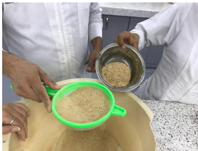
Figura 14. Tamizaje del bagazo molido
