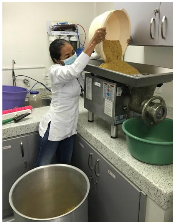
Figura 17. Uso del molino de carne como peletizador
