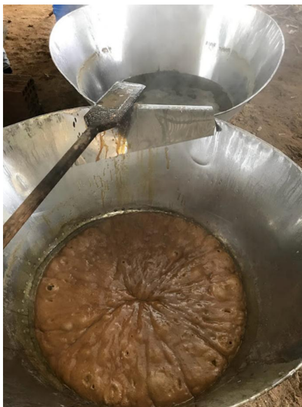
Figura 21. Escaldado del jugo de caña
