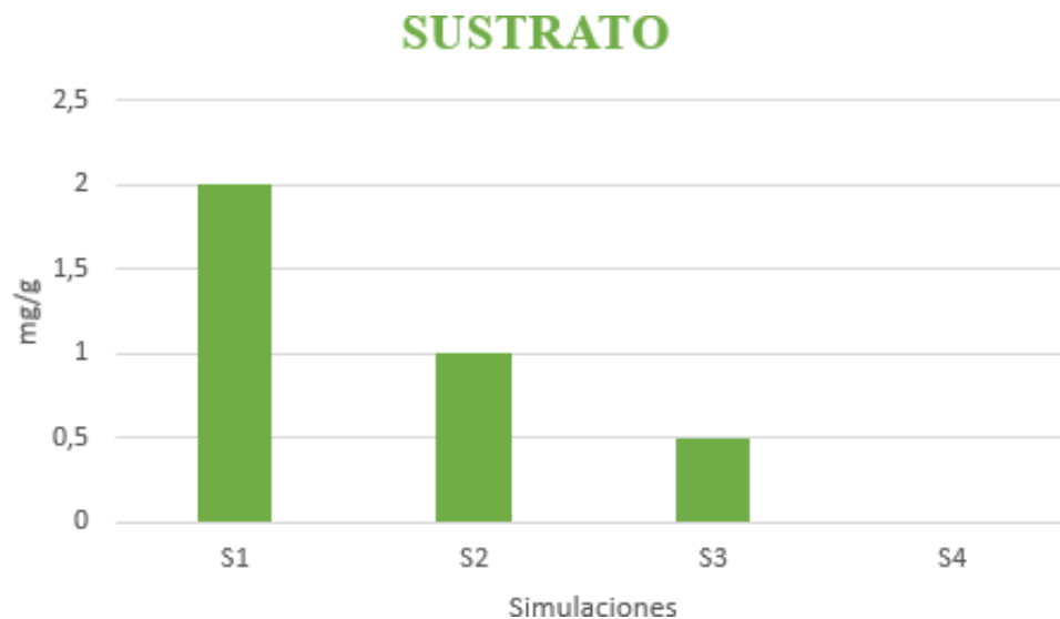
Figura 22. Concentración final del sustrato para las simulaciones en el modo Fed-Batch implementando las siguientes concentraciones iniciales del sustrato: S1: S_0=85 mg/g; S2: S_0= 85 mg/g; S3: S_0=90 mg/g y S4: S_0=90 mg/g, en donde, se puede observar las concentraciones finales después de transcurrir 180 horas.
