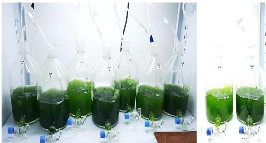
Figura 14. Fotografía de reactores del diseño de experimentos con *Scenedesmus* sp.
