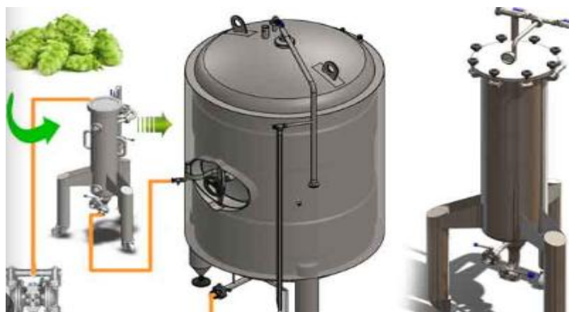
Figura 6. Equipo de acondicionamiento final de cerveza
