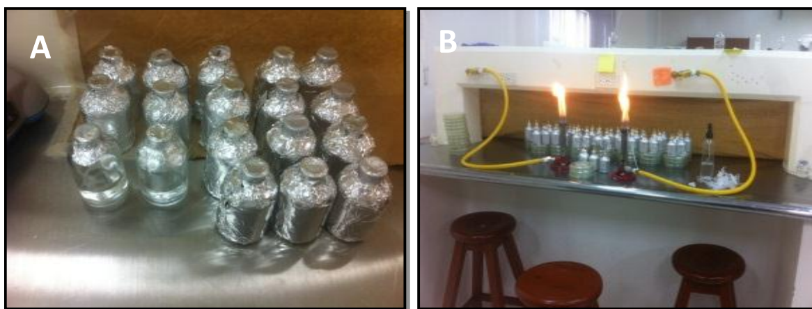
Figura 8. Ensayo a diferentes concentraciones del tolerancia al pesticida clorpirifos de los microorganismos aislados A) frascos con 20ml de medio mínimo mineral envueltos en aluminio, momentos previos a la aplicación de pesticida; B) montaje del ensayo evaluando algunos aislamientos para determinar la tolerancia al pesticida clorpirifos
