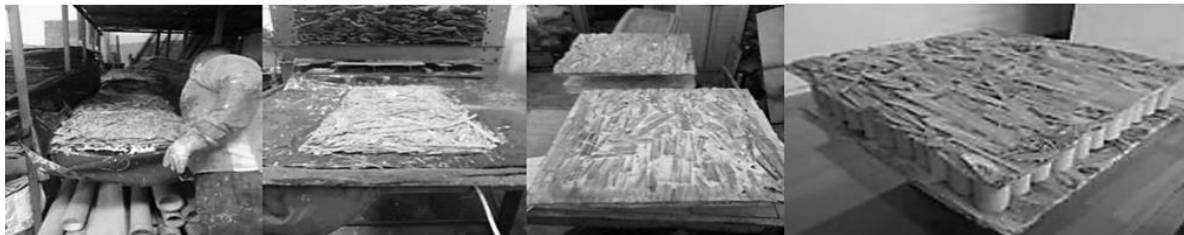
Figura 56. Panel acústico y térmico hecho con residuos de guadua
