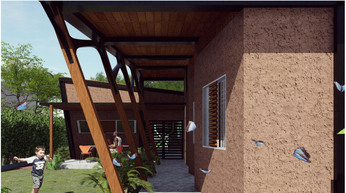
Figura 123. Muros en tierra. Vista posterior
