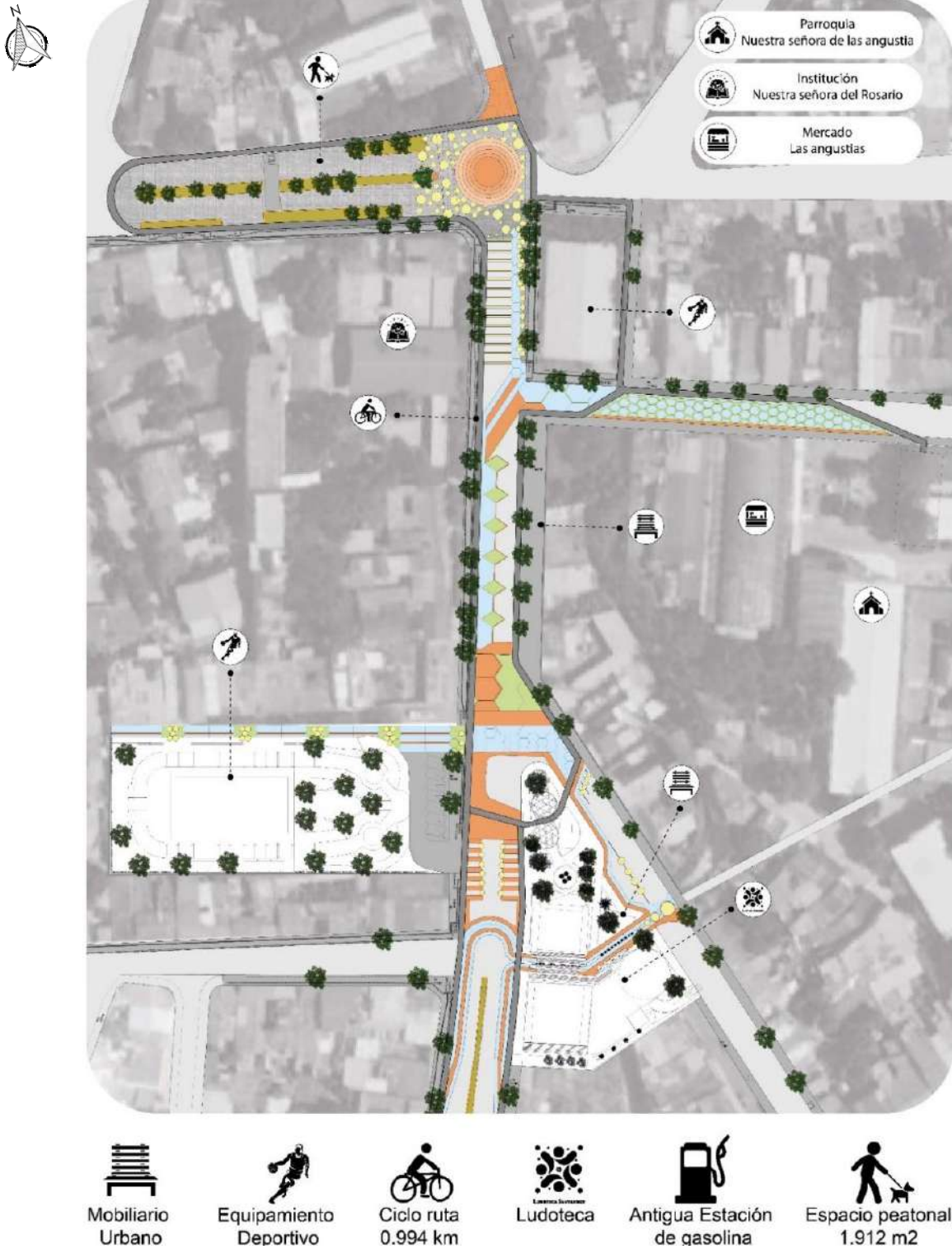
Ilustración 63 . Imagen de Intervención de urbanismo táctico. zonificación de función y usos), diseño urbano-arquitectónica del espacio público, énfasis en el tramado urbano articulador de los dos proyectos arquitectónicos.
