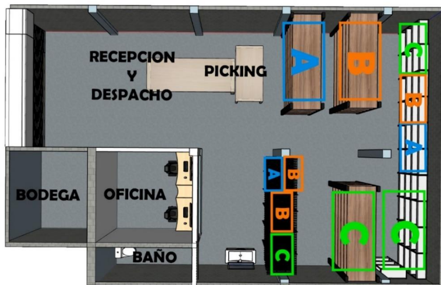
Figura 18. Vista superior del modelo propuesto del almacén
