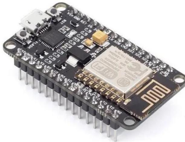
*Figura 4.* Modulo Wifi Nodemcu Amica Esp8266. (Arduino, 2021)
