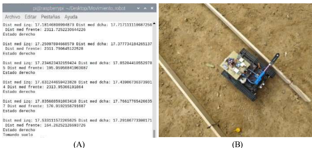
Figura 31. Pruebas de funcionamiento del desplazamiento y sistema de medición.
