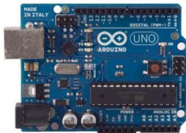
Figura. 3 Arduino uno (Vargas, Castillo, Sandoval, & Brambila, 2015)
