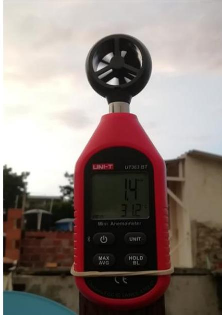
**Figura 1.** Anemómetro fijado en la zona de Torcoroma. Elaboración y fuente propias
