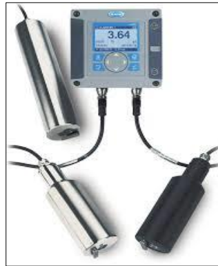
Figura 5. Sonda de inmersión Solitax ts-line sc para medida de turbidez (0,001-4000 NTU).
