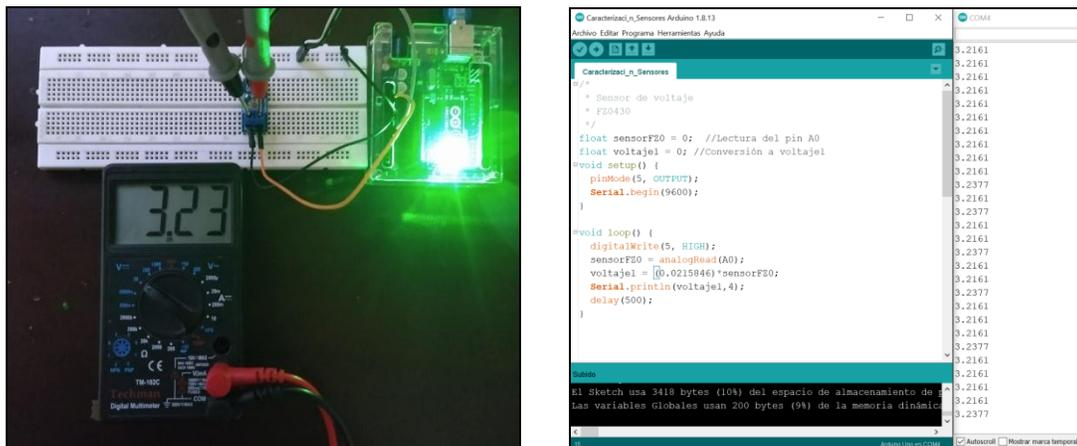
**Figura 54. Comparación de calibración de sensor de voltaje FZ0430**
