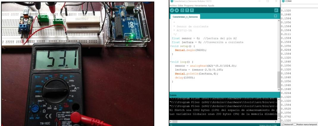
**Figura 57. Lectura de corriente con el sensor KS0185**
