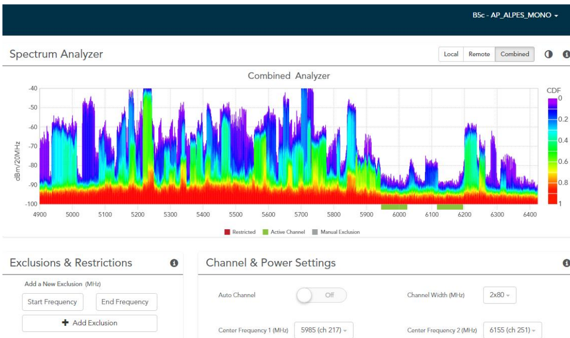
Figura 11. Analizador de espectro del radioenlace Mimoso B5c
