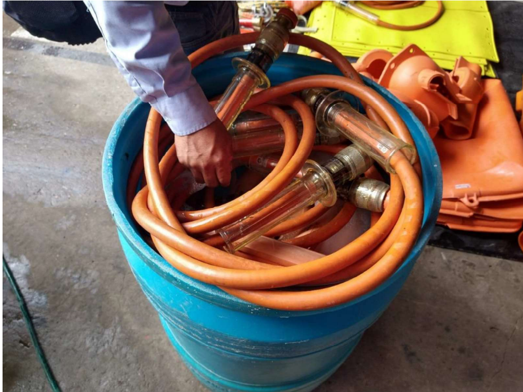
Figura 12 Lavado y Limpieza de equipos dieléctricos
