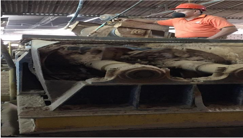
Figura 7. Zona de humidificación de la arcilla.
