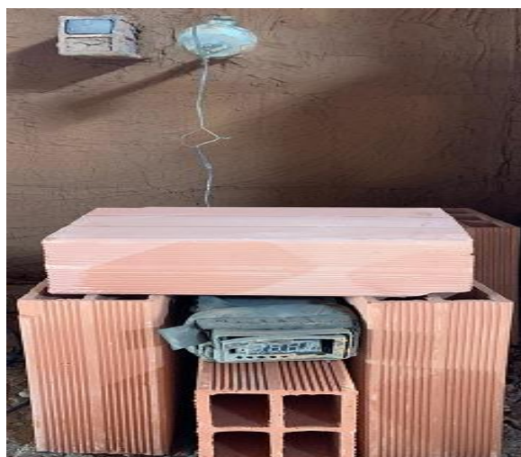
Figura 23. Sensor de temperatura con placa Arduino.
