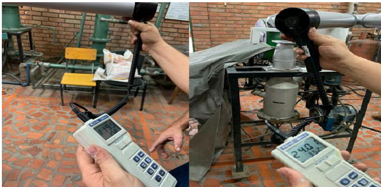
Figura 51. Toma de muestras con anemómetro.
