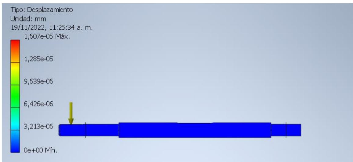
**Figura 54. Deformación del eje**
