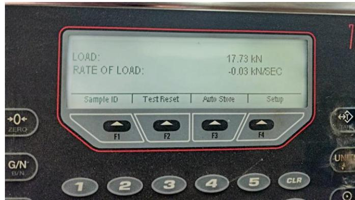
**Figura 60. Carga máxima que soporta a compresión el perfil 45X90**
