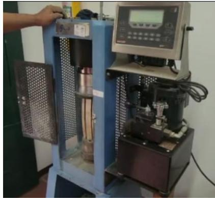
**Figura 57. Ensayo a compresión del perfil 45X90 posición vertical**
