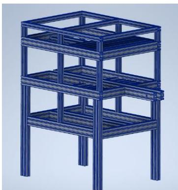
**Figura 56. Estructura o chasis de la descamadora**
