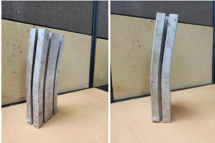
**Figura 75. Perfil sometido a compresión en posición vertical**
