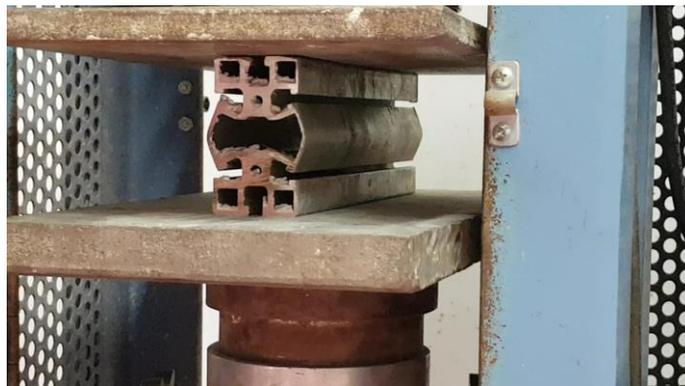
**Figura 59. Ensayo a compresión del perfil 45X90 posición horizontal**
