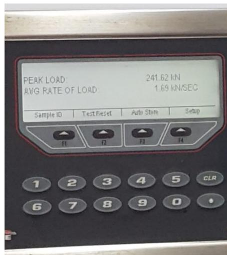
**Figura 58. Carga máxima que soporta a compresión el perfil 45X90**
