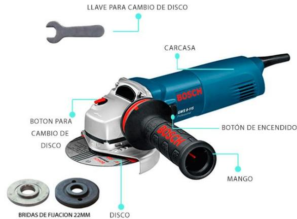
Figura 12. Principales componentes de la pulidora.
