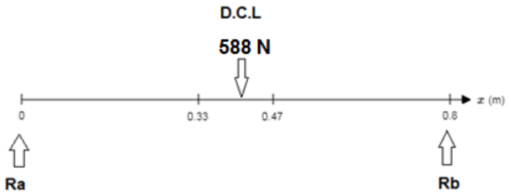
Figura 48. Diagrama de cuerpo libre de base del pupitre.
