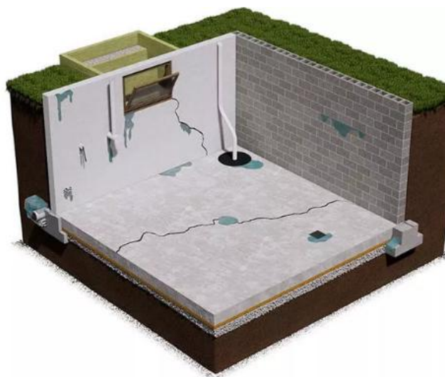
Figura 93. Filtración en Muros y Piso de la Estructura
