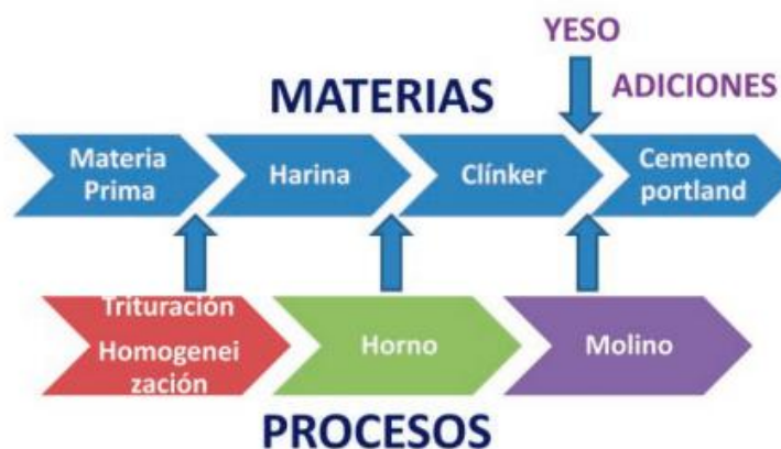
Figura 1. Esquema General de Fabricación del Cemento
