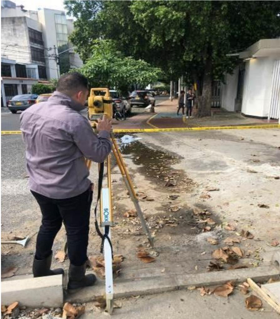
**Figura 12. Levantamiento topográfico**
