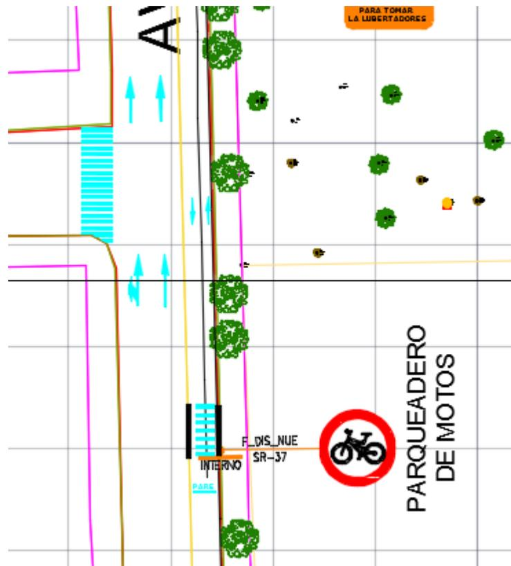
**Figura 87. Propuesta señalización horizontal y vertical (parqueadero de motos )**
