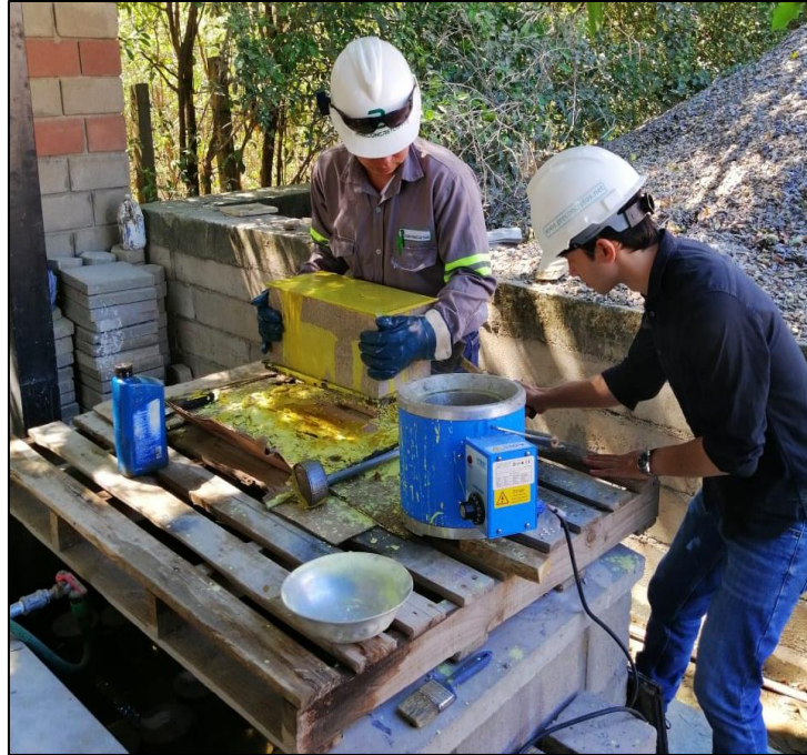
Figura 9. Proceso de refrentado de los bloques a ensayar. Fuente Autores.
