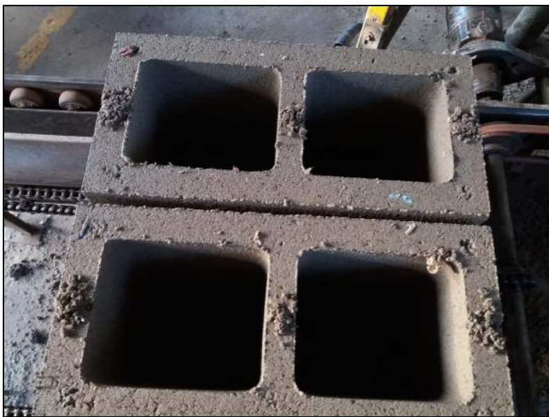
Figura 6. Bloques elaborados con material ecoestéril.
