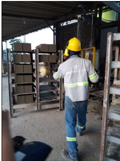
Figura 7. Transporte de los bloques a las cámaras de curado. Fuente Autores.
