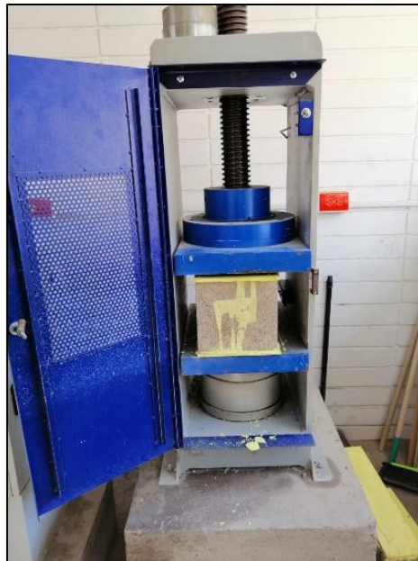
Figura 10. Prensa universal UTC-4131 donde se sometieron los boques a cargas compresivas. Fuente Autores.
