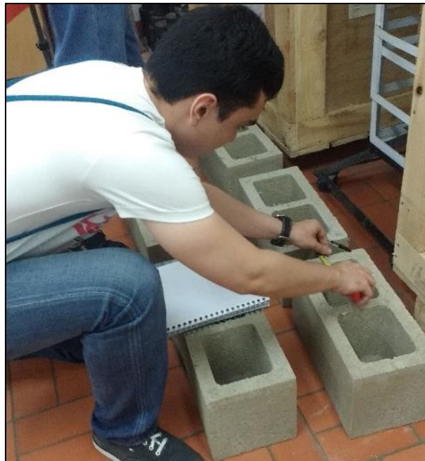
Figura 8. Medición de las dimensiones de los bloques. Fuente Autores.
