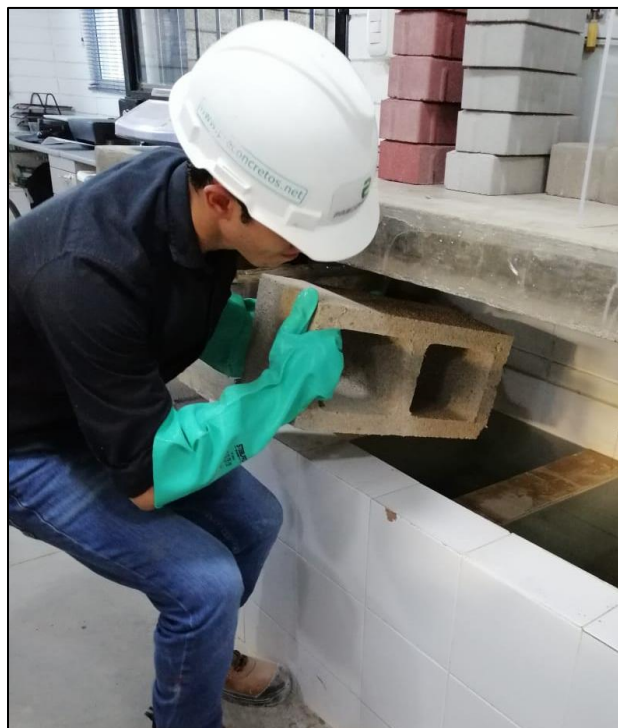
Figura 15. Inmersión de los bloques en las piscinas con agua. Fuente Autores.
