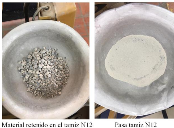
Figura 17. Desgaste en la máquina de los Ángeles
