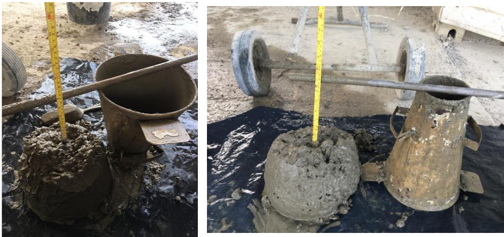
Figura 19. Pruebas de asentamiento
