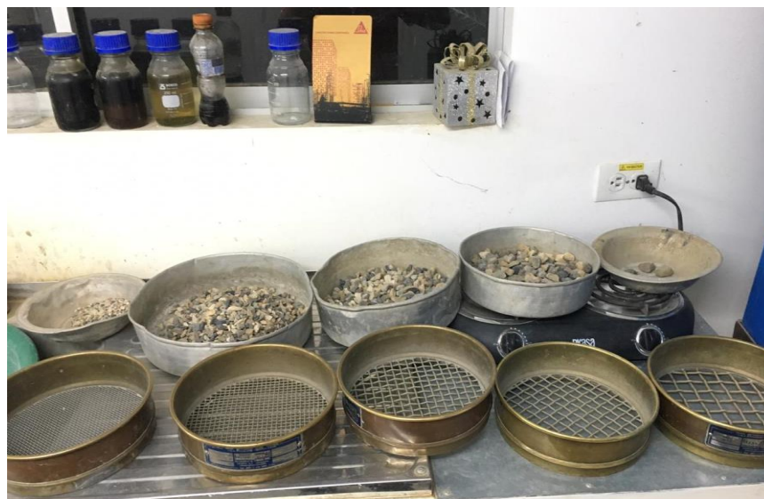
Figura 10. Ensayo de granulometría agregado grueso natural TMN ¾”
