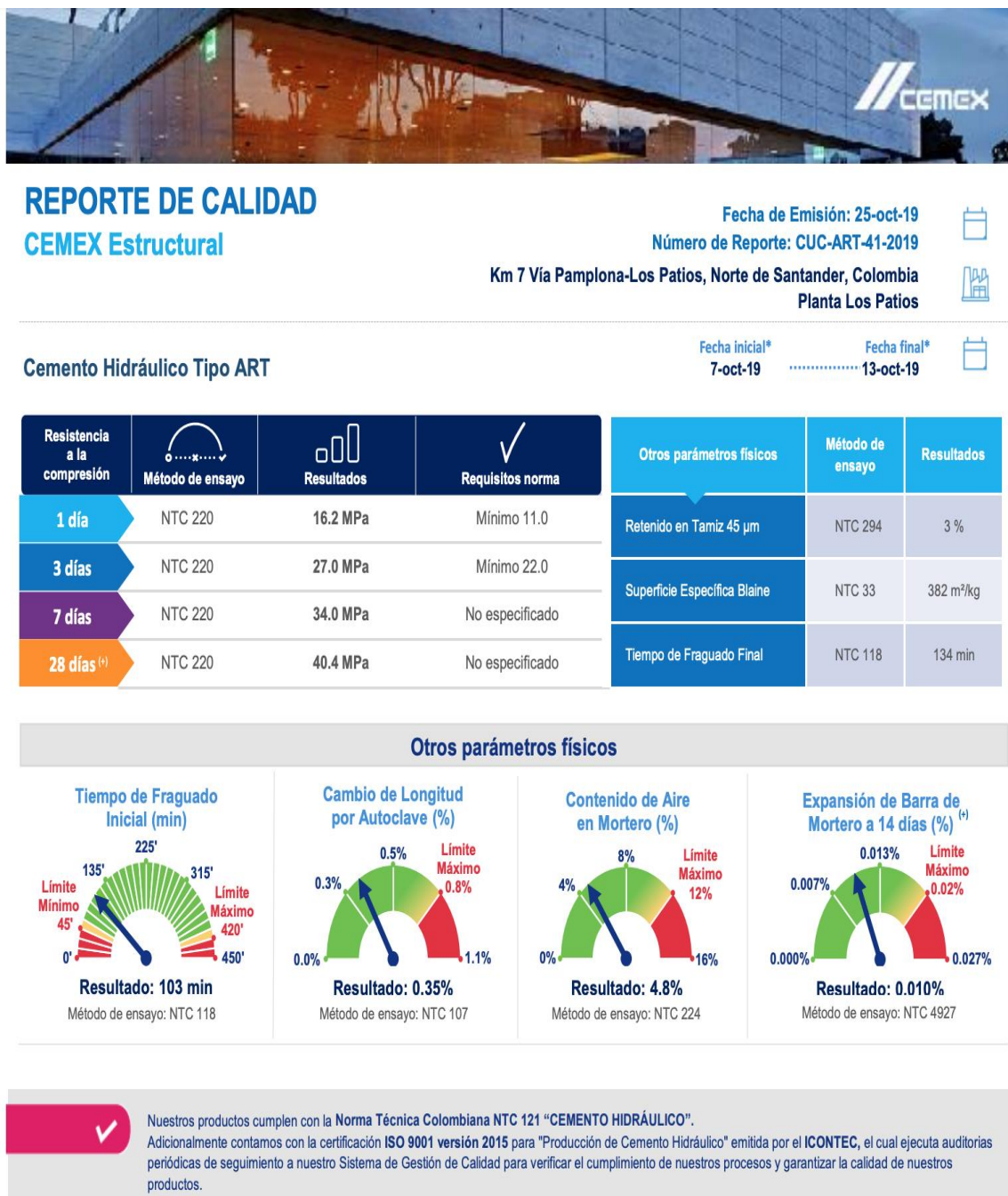
Figura 6. Reporte de calidad del cemento CEMEX estructural usado en el proyecto
