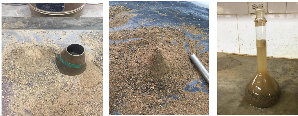
Figura 8. Montaje del ensayo de peso específico y absorción del agregado fino (arena de trituración)
