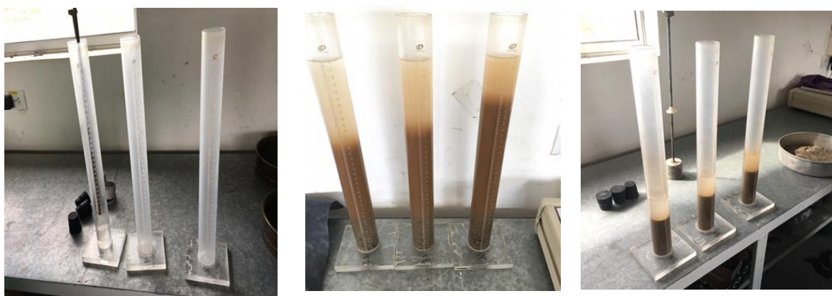
Figura 9. Montaje del ensayo de equivalente de arena
