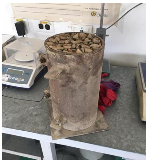
Figura 11. Molde lleno con muestra de agregado grueso natural ¾”
