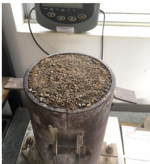
Figura 7. Molde lleno con muestra de arena de trituración
