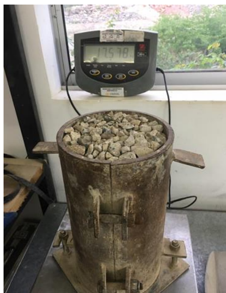
Figura 15. Molde lleno con muestra de agregado grueso reciclado ¾”, 3000 psi 56 dí
