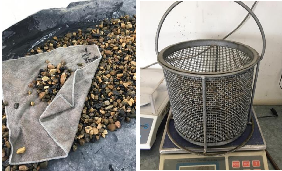
Figura 12. Montaje de laboratorio de peso específico y absorción del agregado grueso (triturado natural ¾")
