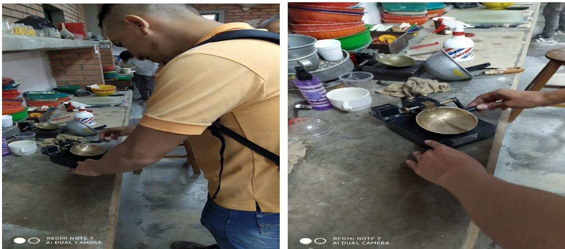
Figura 6 Determinación de límite líquido (cazuela de Casagrande) Fuente: autor
