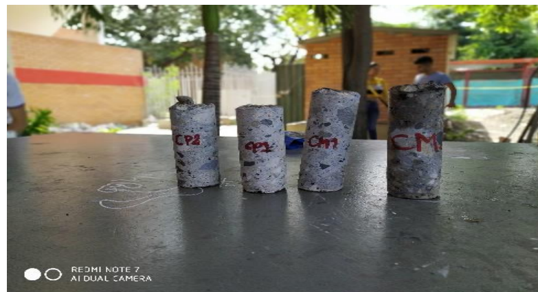
Figura 8 Extracción de núcleo de concreto Fuente: Autor
