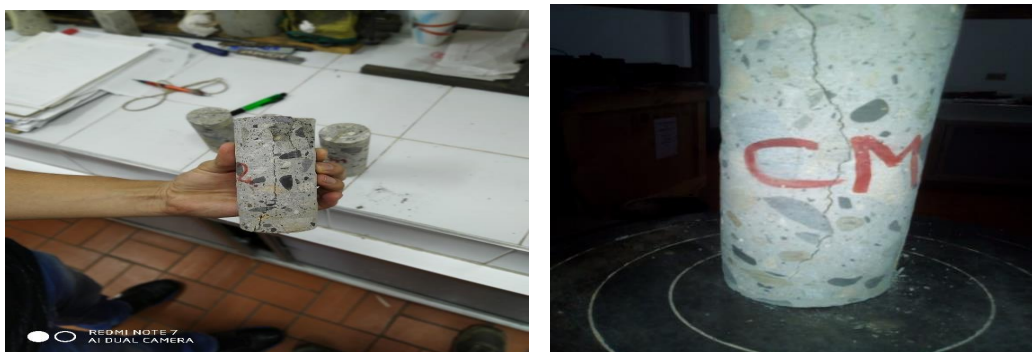
Figura 12 Probetas falladas en maquina universal Fuente: Autor
