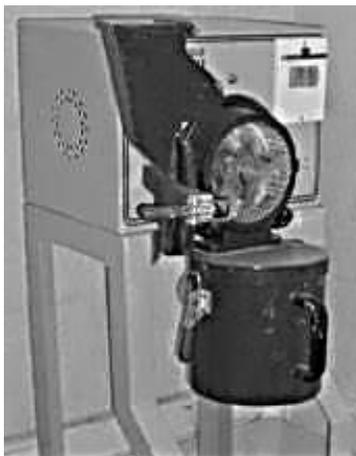
**Figura 9. Molino de martillos (molienda vía seca)**
