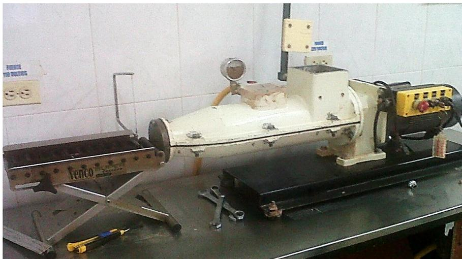
**Figura 7. Extrusora de laboratorio con vacío**
