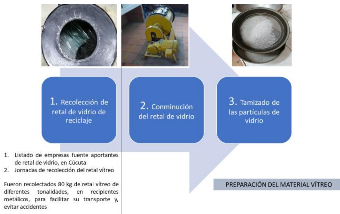
Figura 40. Preparación (conminución y tamizado) del material vítreo
