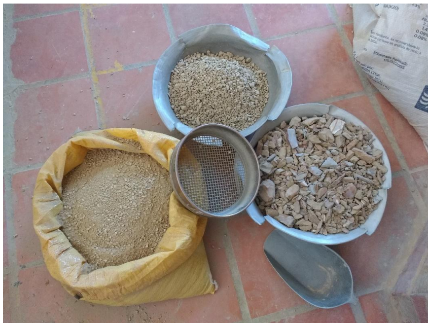
Figura 33. Textura de la arcilla, producto de procesos de disgregación y tamizado
