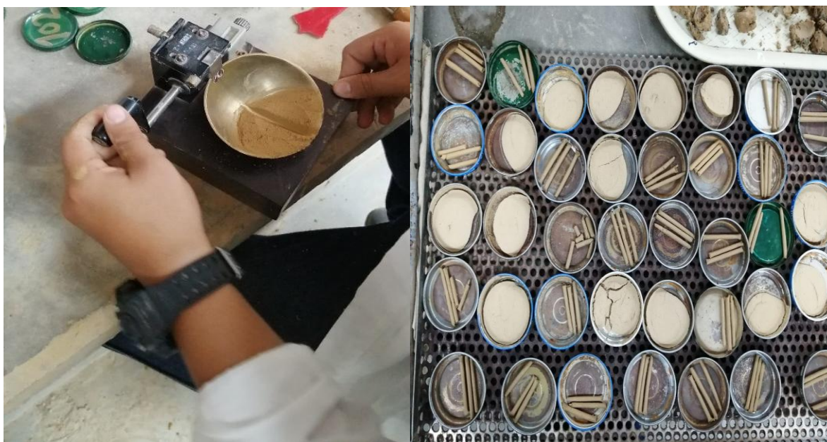
Figura 34. Ensayo de límite líquido y límite plástico
