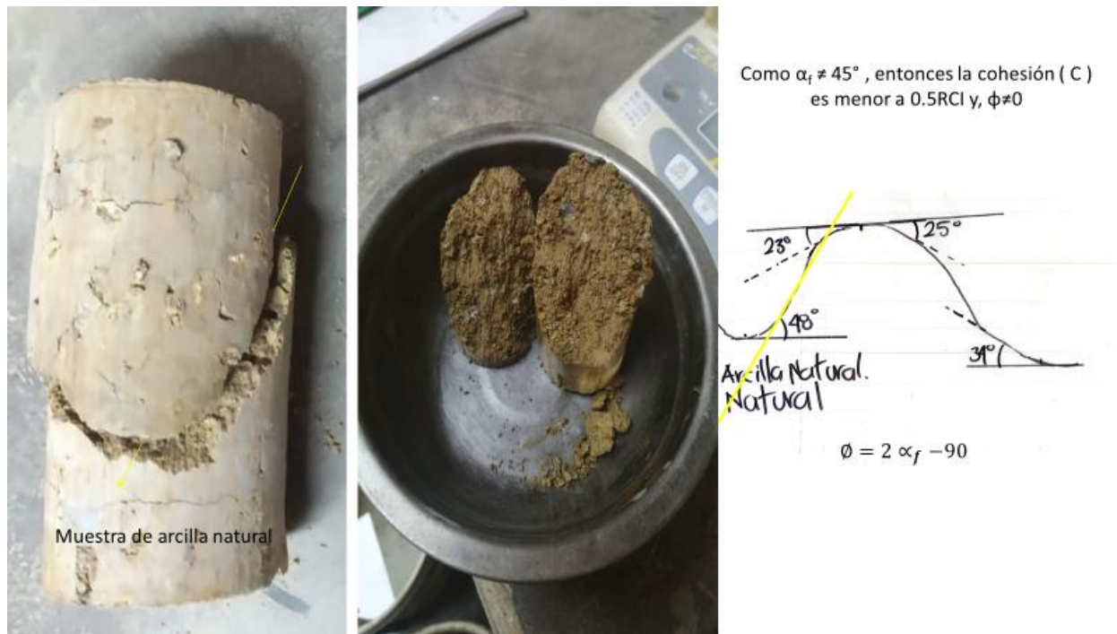
Figura 51. Patrón de falla de la muestra de arcilla natural
