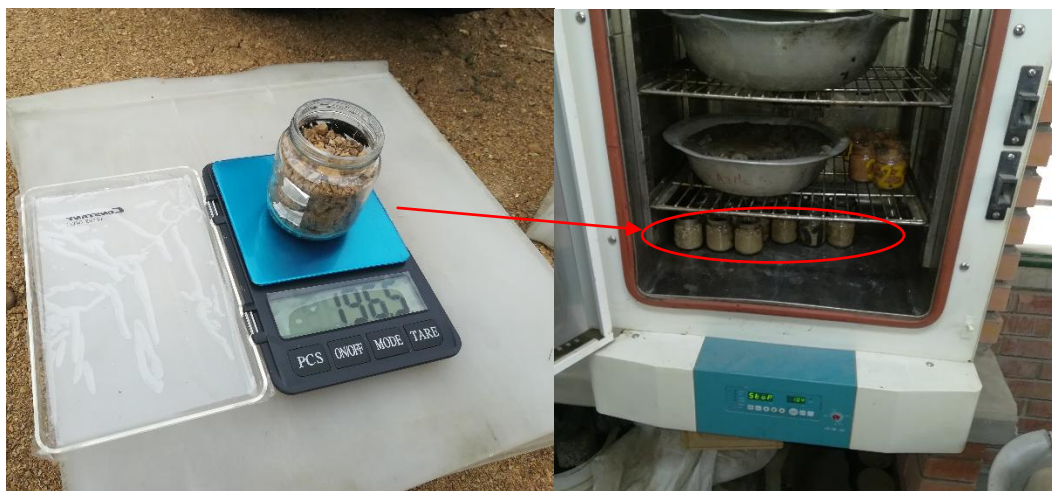
Figura 28. Determinación de humedad
