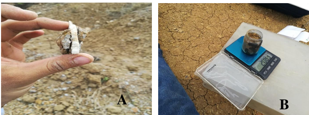
Figura 22. Yeso encapsulado y toma de datos en campo para ensayo de humedad, sector los Cerezos
