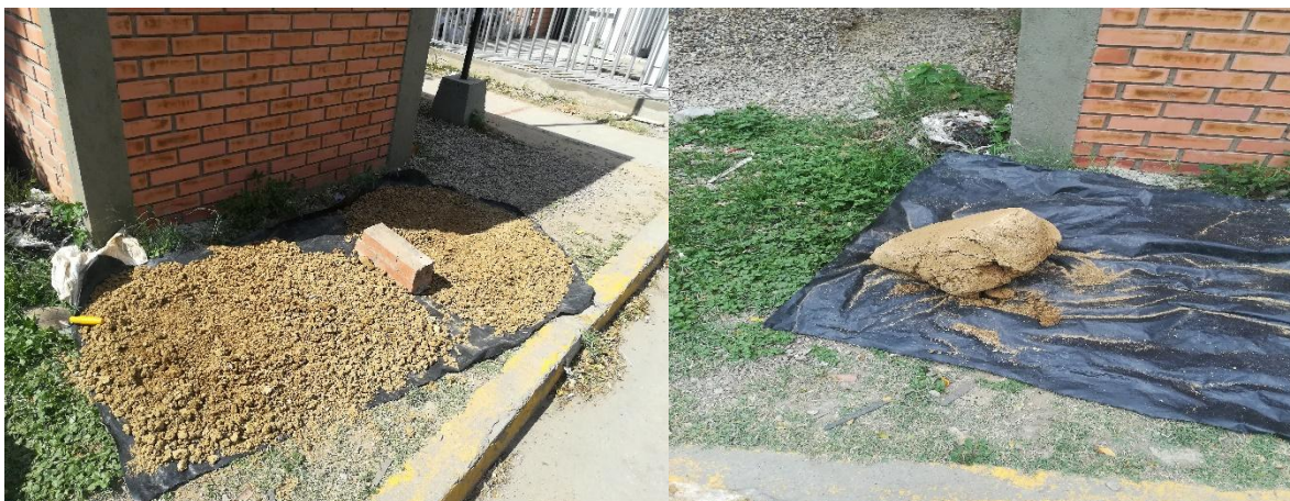
Figura 32. Secado de las muestras para la ejecución de ensayos de laboratorio
