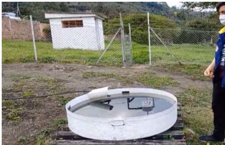
Figura 32. Tanque de Medición de Evaporación, Estación Meteorológica Manual (IDEAM).
