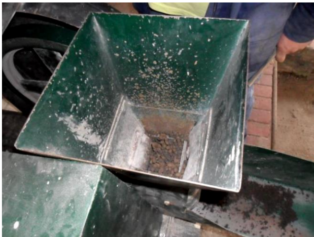
Figura 112. Proceso de trituración con trituradora de mandíbulas. (Silva, 2018)
