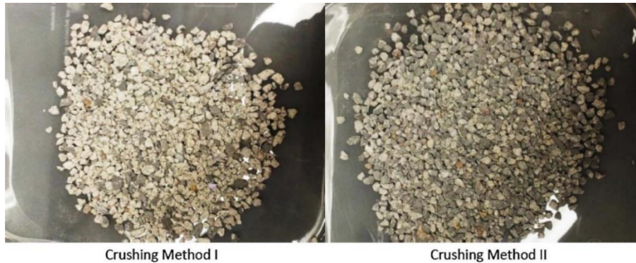
Figura 128. Muestra agregada preparada utilizando los métodos de trituración I y II. (Johnson & Shehata, 2016)
