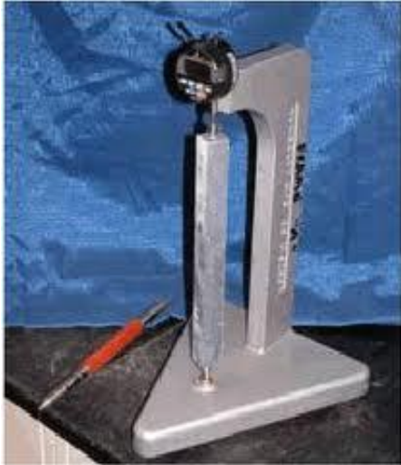
Figura 114. Comparador de caratula empleado en el ensayo ASTM C1260. (Silva, 2018)
