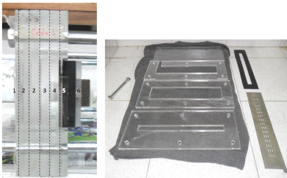
Figura 119. a ) secuencia de las laminas de celda y b) algunos de los elementos elaborados para el ensamblaje de las celdas. (Silva, 2018)
