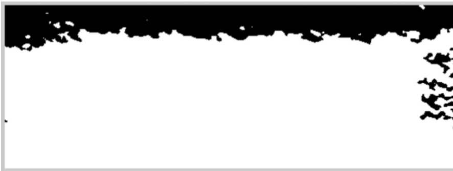
Figura 54. Imagen binaria en la que se llenan los agujeros en la región no carbonatada. Choi, J., Lee, Y., Yong, Y., & Yeon, B. (2017).
