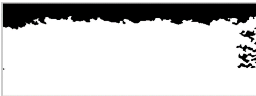
Figura 55. Imagen binaria en la que se eliminan los píxeles blancos detectados erróneamente fuera de la región no carbonatada. Choi, J., Lee, Y., Yong, Y., & Yeon, B. (2017).
