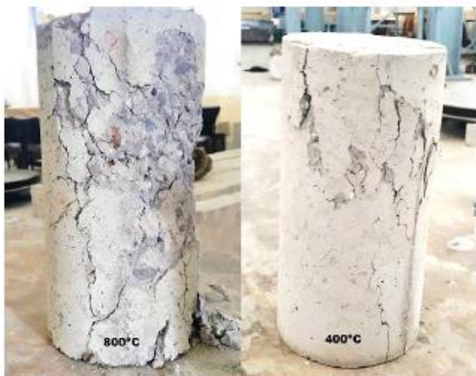
Figura 204. Modo de falla en compresión (muestras calentadas). Fuente: (Ahmad et al., 2018).
