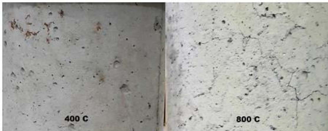
Figura 201. Estado de la superficie de las muestras después de la exposición a temperatura elevada. Fuente: (Ahmad et al., 2018)
