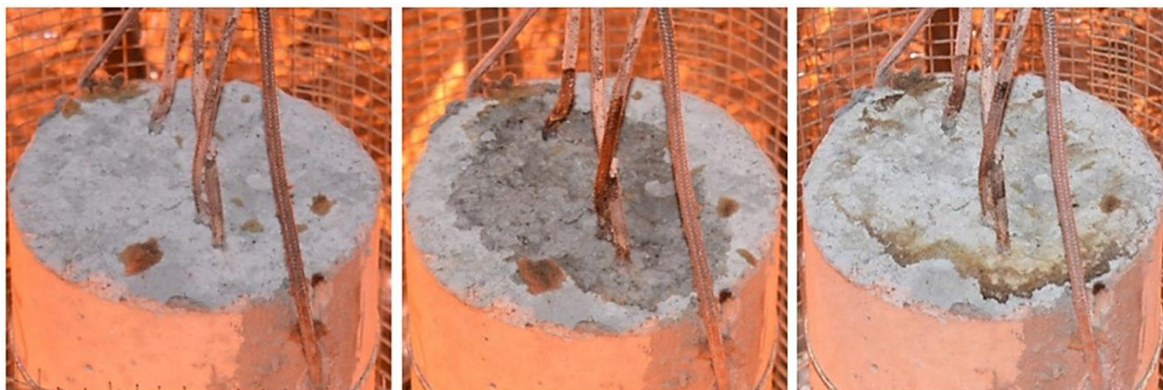
Figura 159. Migración de agua / sangrado en la parte superior de la superficie de la muestra. (Le et al., 2018)
