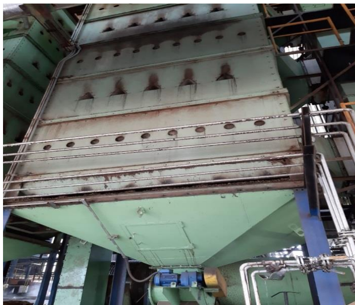
Figura 7 Silo de secado de nuez/almendra
