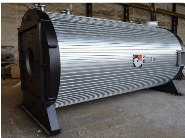
Figura 6 Caldera de biomasa
