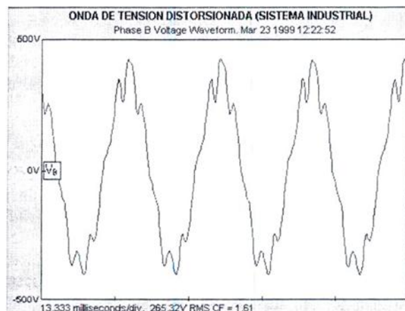
Figura 9. Forma de señal de tensión distorsionada, medida en un sistema industrial
