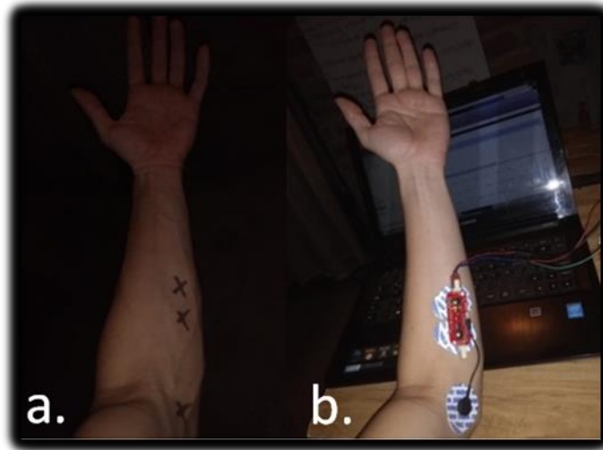
(a) Marcación y (b) Ubicación del sensor en el antebrazo para toma de muestras de las señales musculares
