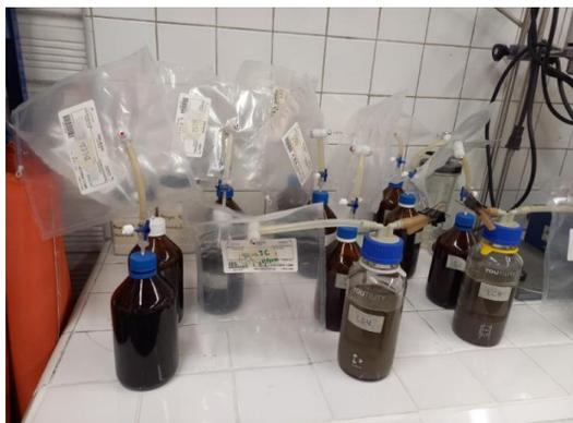
Figura 29. **Montaje experimental del lodo san Fernando y lodo codigestión**
