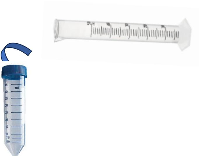
Figura 21. **Probeta con tubo falcon**
