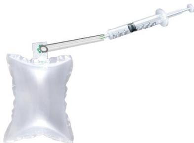
Figura 34. **Bolsa Tedla para medición de biogas**
