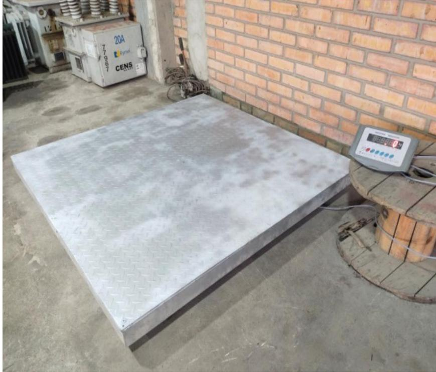
**Figura 21. Báscula Industrial ubicado en Interferías-Cúcuta.**
