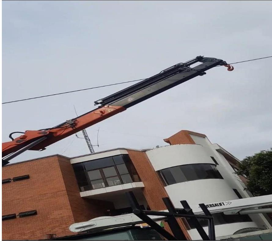
**Figura 68. Prueba preventiva de extensiones hidráulicas.**
